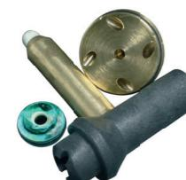
Die Aquadrill Düse ist ausgestattet mit einem rotierenden Vorstrahl und Keramik-einsätzen. Die Düse ist perfekt um vertikale Rohre von Verstopfungen und Fetten zu reinigen. Der zulässige Wasserdruk liegt bei 150 bar mit einer Wassertemperatur von bis zu 60°C.
