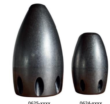
La buse Aquadrill est équipée d'un pré-jet rotatif et d'inserts en céramique. L'outil aquadrill est idéal pour le nettoyage de canalisations encombrées de dépôts gras. La pression d'eau autorisée est de 150 bars avec une température d'eau allant jusqu'à 60°C.
